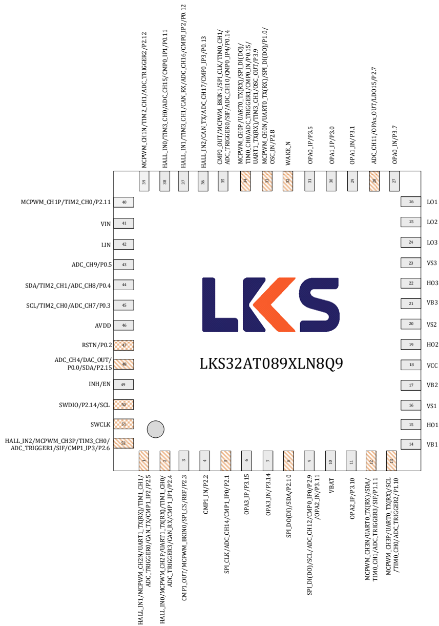
图 3-1 LKS32AT089XLN8Q9 管脚分布图
