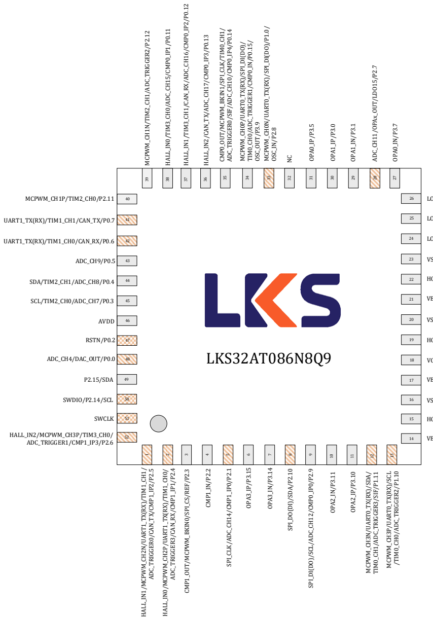
图 3-1 LKS32AT086N8Q9 管脚分布图
